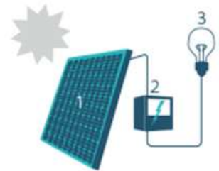
1. Zonnepaneel | 2. Omvormer | 3. Elektrische toestellen
