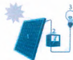
1. Zonnepaneel | 2. Omvormer | 3. Elektrische toestellen
