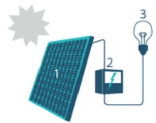
1. Zonnepaneel | 2. Omvormer | 3. Elektrische toestellen
