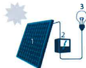
1 Zonnepaneel | 2 Omvormer 3 Elektrische meter
