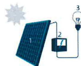
1 Zonnepaneel | 2 Omvormer | 3 Elektrische toestellen
