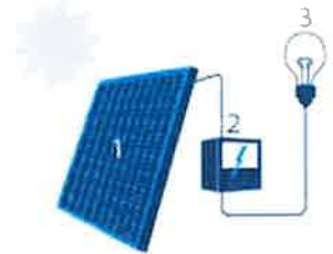
1. Zonnepaneel | 2. Omvormer | 3. Lichtbron
