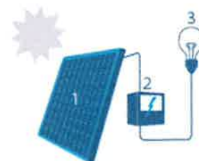
1. Zonnepaneel | 2. Omvormer 3. Elektrische toestellen
