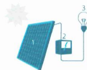
1. Zonnepaneel | 2. Omvormer | 3. Elektrische toestellen
