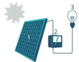
1. Zonnepaneel | 2. Omvormer | 3. Elektrische toestellen
