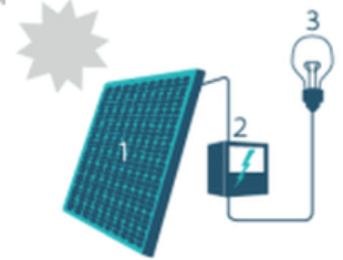
1. Zonnepaneel | 2. Omvormer | 3. Elektrische toestellen
