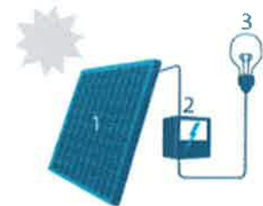
1 Zonnepaneel | 2 Omvormer | 3 Elektrische toestellen
