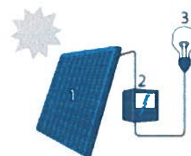
1. Zonnepaneel | 2. Omvormer | 3. Elektrische toestellen
