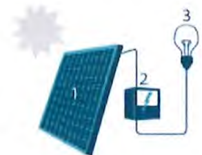
1. Zonnepaneel | 2. Omvormer | 3. Elektrische toestellen
