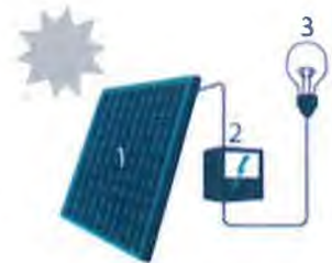
1. Zonnepaneel | 2. Omvormer | 3. Elektrische toestellen
