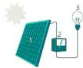
1. Zonnepaneel | 2. Omvormer | 3. Elektrische toestellen
