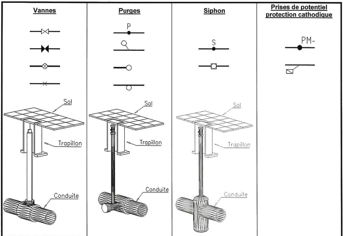
Ces éléments remontent d'office à la surface du sol et sont en principe surmontés d'un trapillon. Toutefois, en fonction des différents travaux qui ont pu avoir lieu après leur pose, ces trapillons peuvent ne plus être visibles et une grande prudence est donc de mise.
