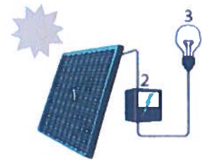
1. Zonnepaneel | 2. Omvormer | 3. Elektrische toestellen
