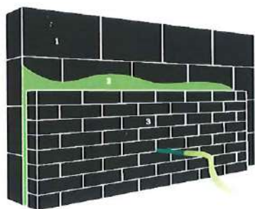
1. Dragende muur | 2. Ingeblazen isolatie | 3. Gevelsteen / gevelbekleding
