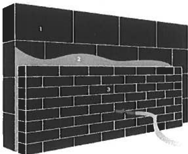
1. Dragende muur | 2. Ingeblazen isolatie | 3. Gevelsteen / gevelbekleding
