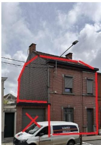
Le volume protégé d'un logement reprend tous les espaces du logement que l'on souhaite protéger des déperditions thermiques que ce soit vers l'extérieur, vers le sol ou encore des espaces non chauffés (cave, annexe, bâtiment mitoyen...). Il comprend au moins tous les locaux chauffés. Lorsqu'une paroi dispose d'un isolant thermique, elle délimite souvent le volume protégé.
