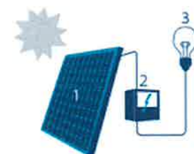
1. Zonnepaneel | 2. Omvormer | 3. Elektrische installatie
