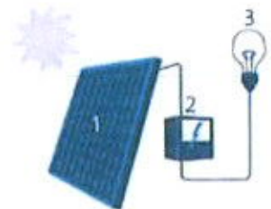
1 Zonnepaneel 2 Batterij 3 Lichtbron (De Zonnepaneel)
