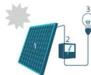
1. Zonnepaneel | 2. Omvormer | 3. Elektrische toestellen
