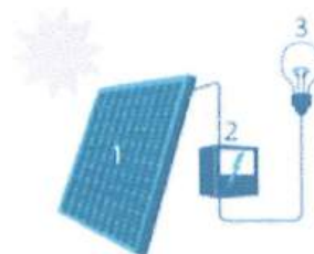
1. Zonnepaneel | 2. Omvormer 3. Elektrische toestel
