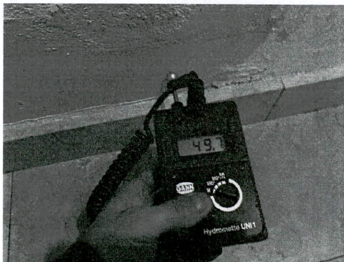
Afb3: Metingen tonen geen verhoogde vochtwaarden in de muren van de inkomhal.
