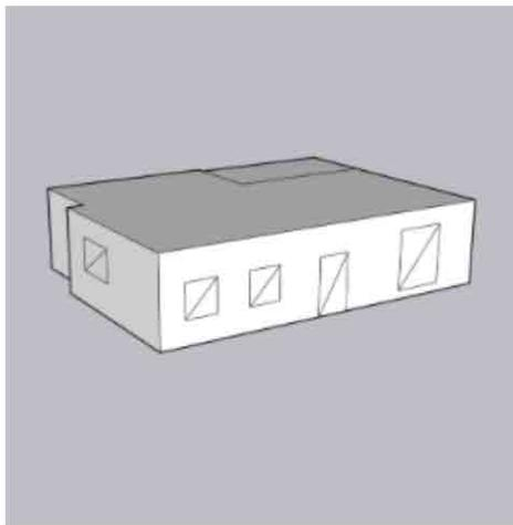
Le volume protégé d'un logement reprend tous les espaces du logement que l'on souhaite protéger des déperditions thermiques que ce soit vers l'extérieur, vers le sol ou encore des espaces non chauffés (cave, annexe, bâtiment mitoyen...). Il comprend au moins tous les locaux chauffés. Lorsqu'une paroi dispose d'un isolant thermique, elle délimite souvent le volume protégé.
