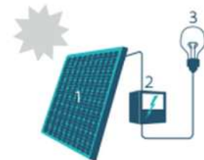
1. Zonnepaneel | 2. Omvormer | 3. Elektrische toestellen
