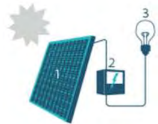
1. Zonnepaneel | 2. Omvormer | 3. Elektrische toestellen
