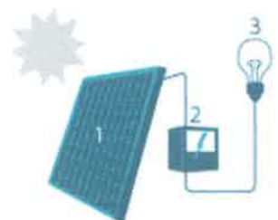
1. Zonnepaneel | 2. Omvormer | 3. Elektrische toestellen
