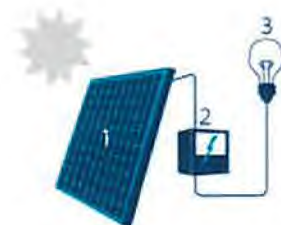
Zonnepanelen (1) omzetten in elektriciteit (2) die gebruikt kan worden (3).
