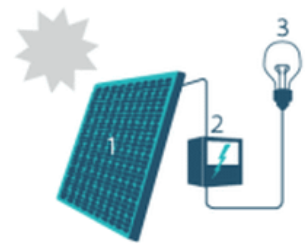
1. Zonnepaneel | 2. Omvormer | 3. Elektrische toestellen
