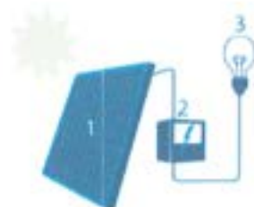
1 Zonnepaneel met 2 Omvormer / 3 Elektrische aansluiting
