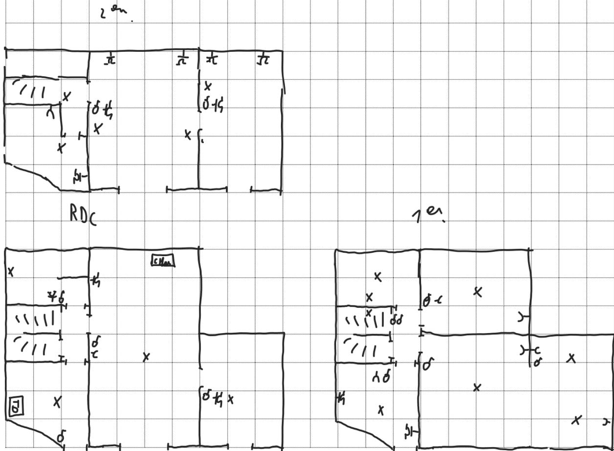
Ce croquis n'a pour but que de fixer, au moment du contrôle, l'étendue de l'installation ou de la partie de l'installation initiée avant octobre 1981. Il ne peut en aucun cas remplacer le schéma unifilaire ou le plan de position dont l'absence au moment du contrôle constitue une infraction.
