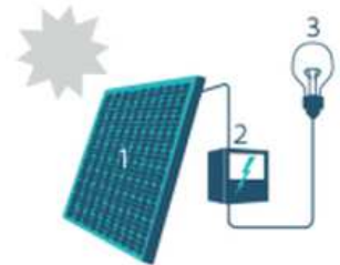
1. Zonnepaneel | 2. Omvormer | 3. Elektrische toestellen
