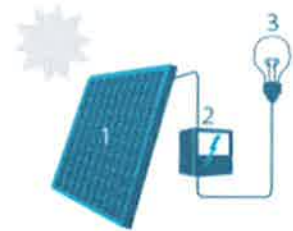
1. Zonnepaneel | 2. Omvormer | 3. Elektrische toestellen
