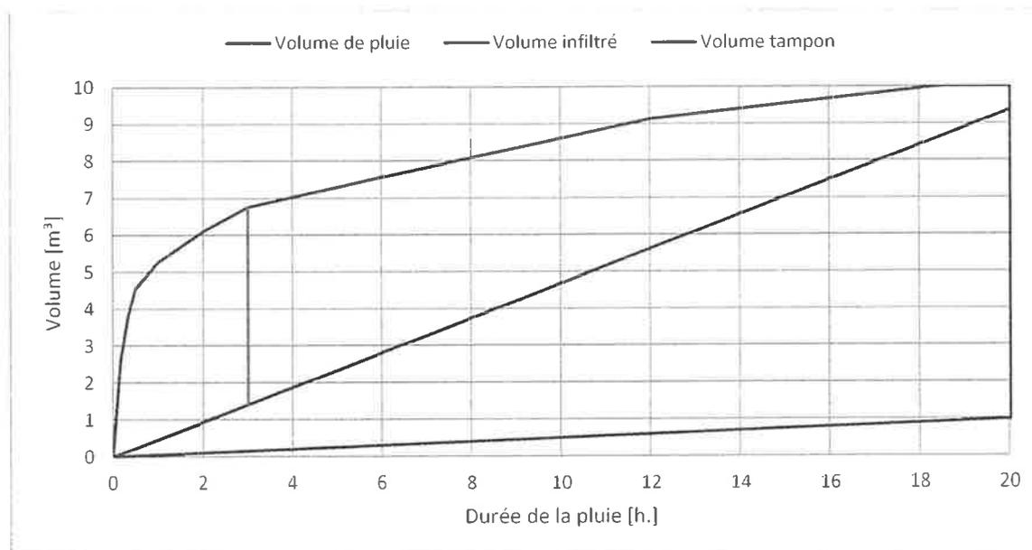
**Il est nécessaire de mettre en œuvre un volume tampon de 5,35 m<sup>3</sup> qui sera relié à une évacuation à débit régulé à 0,13 l./sec.** Le volume tampon doit être vidangé en moins de 12 heures pour pouvoir absorber une nouvelle pluie. Dans notre cas, il sera vidangé en 11 heures et 26 minutes.
