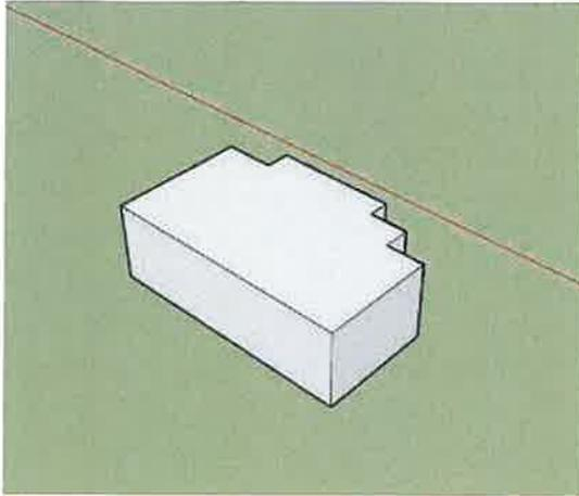
Le volume protégé d'un logement reprend tous les espaces du logement que l'on souhaite protéger des déperditions thermiques que ce soit vers l'extérieur, vers le sol ou encore des espaces non chauffés (cave, annexe, bâtiment mitoyen...). Il comprend au moins tous les locaux chauffés. Lorsqu'une paroi dispose d'un isolant thermique, elle délimite souvent le volume protégé.
