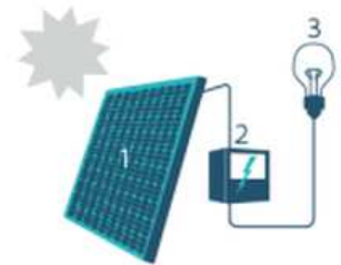
1. Zonnepaneel | 2. Omvormer | 3. Elektrische toestellen
