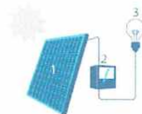
1 Zonnepaneel 2 Omvormer 3 Elektrische lamp
