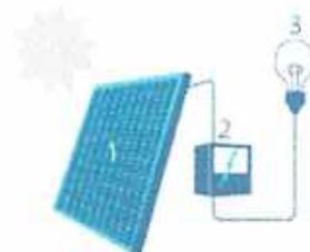
1. Zonnepaneel | 2. Omvormer | 3. Elektrische aansluiting
