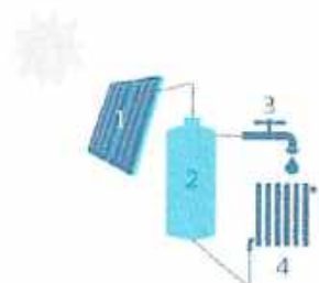
1. Zonnecollector | 2. Opslagvat voor warm water | 3. Tapkran warm water | 4. Afschlechting voor ruimteverwarming (radiatoren)
