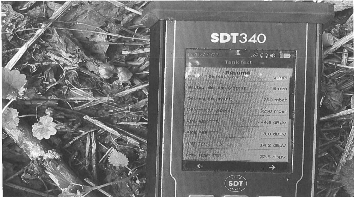
Enregistrement des capteurs avec la fuite calibrée
