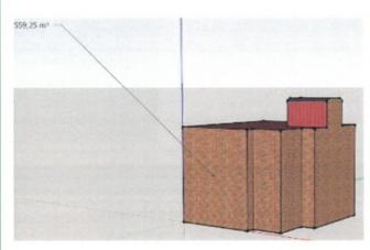
Le volume protégé d'un logement reprend tous les espaces du logement que l'on souhaite protéger des déperditions thermiques que ce soit vers l'extérieur, vers le sol ou encore des espaces non chauffés (cave, annexe, bătiment mitoyen...). Il comprend au moins tous les locaux chauffés. Lorsqu'une paroi dispose d'un isolant thermique, elle délimite souvent le volume protégé.
