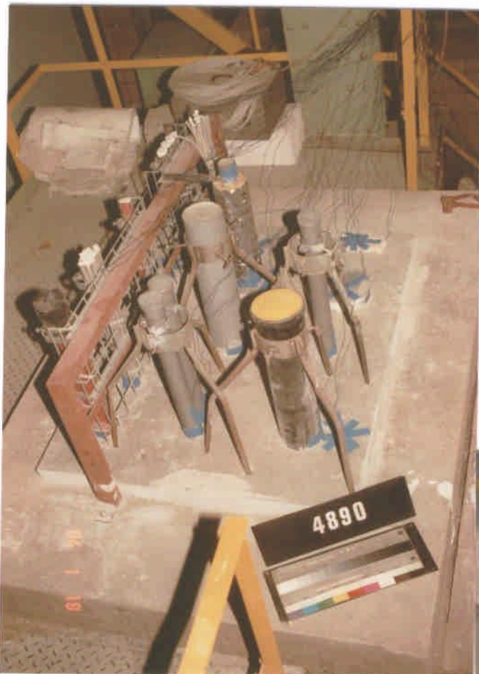
Vóór de proef : de niet- blootgestelde zijde van het proefelement
