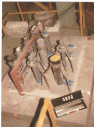
Vóór de proef : de niet-blootgestelde zijde van het samengestelde proefelement
