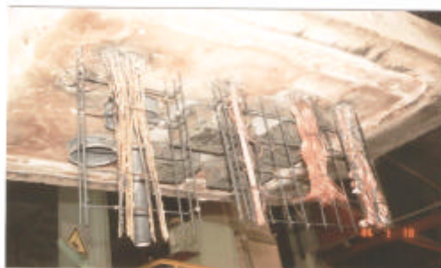
Na de spuitproef : de blootgestelde zijde van het proefelement
