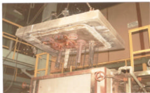
Na 123 minuten : het proefelement wordt van de oven verwijderd.
