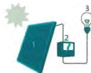
1. Zonnepaneel | 2. Omvormer | 3. Elektrische toestellen
