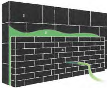
1. Dragende muur | 2. Ingeblazen isolatie | 3. Gevelsteen / gevelbekleding
