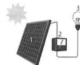
1 Zonnepaneel | 2 Inverter | 3 Elektrische aansluiting
