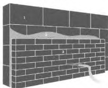
1. Dragende muur | 2. Ingeblazen isolatie | 3. Gevelsteen / gevelbekleding
