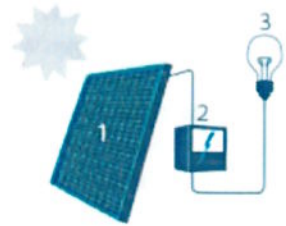
1. Zonnepaneel | 2. Omvormer | 3. Elektrische toestellen
